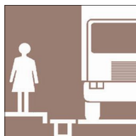
clase C 250 laterales de bordillo y áreas sin tráfico directo
